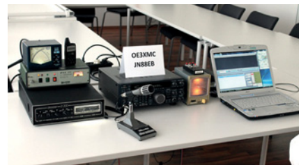
Die verwendete Station Transceiver: Kenwood TS-850 VHF Transverter: SSB Electronic LT2S Endstufe: Dressler D200s ca.500W Vorverstärker: SSB Electronic SP2 Antennen: 2x9 Element F9FT vertikal gestockt
