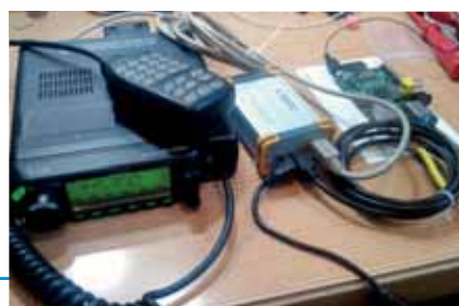
D-Star Simplex Repeater mit 9k6-fähigem Funkgerät, DVRPTR und Raspberry Pi, Model B mit Internetzugang über Ethernet bzw. USB-WLAN-Stick (von links nach rechts)
