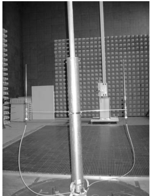
Modellaufbau zur Ermittlung der Strahlungscharakteristik.
