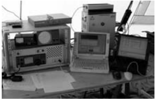
Die Meteor-Scatter Station bestehend aus IC910, jeweils einem Notebook für PR und Meteor-Scatter sowie dem Rotorsteuergerät.
