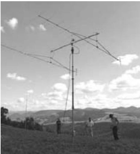
Zwei 17-Element VHF Yagis auf Kurbelmast montiert. Elevation ca. 5°.
