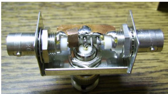
Abb. 1: Zusätzliche Masseverbindung am Exemplar OE5GPL.
