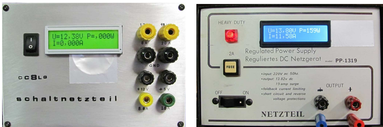
Bild 02 und 03: In vorhandene Netzgeräte nachträglich eingebaute Module
