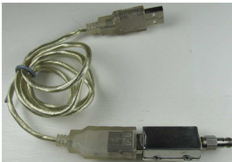
Bild 16: USB-DVB-T-Stick in Metallgehäuse eingebaut
