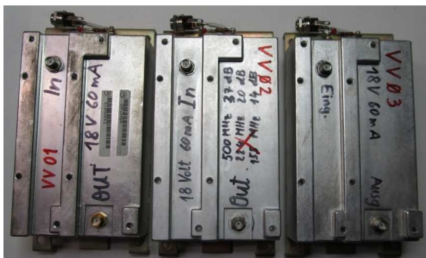
Bild 25: Antennenvorverstärker VV01, VV02, VV03
