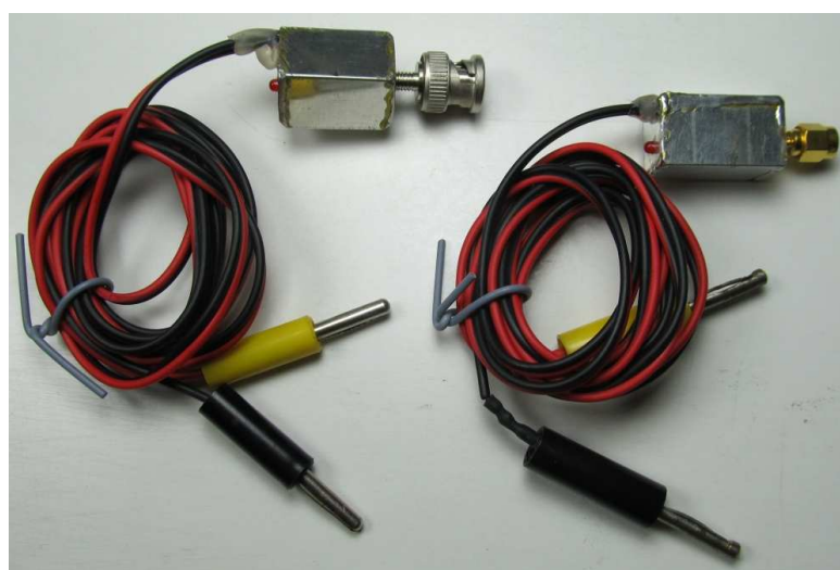
Bild 11: Zwei einfache Rauschgeneratoren
