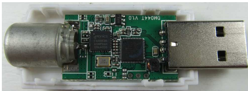
Bild 14: USB-DVB-T-Stick mit geöffnetem Gehäuse
