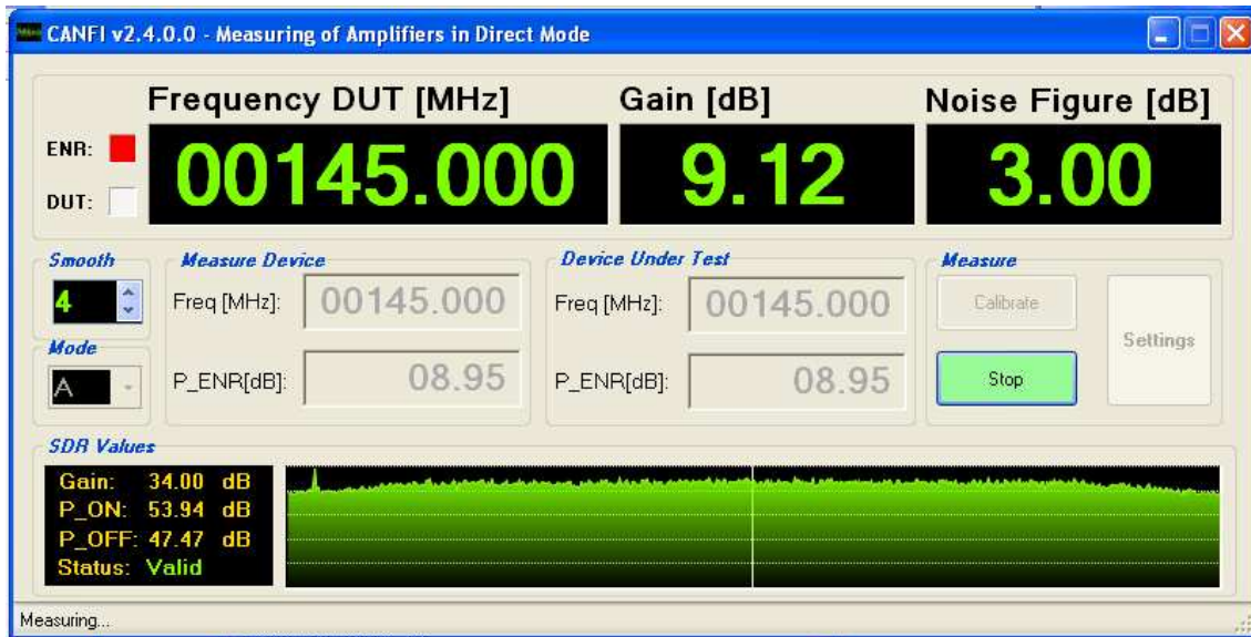
Bild 20: CANFI Störungs-Spitze in Spektrumsanzeige
