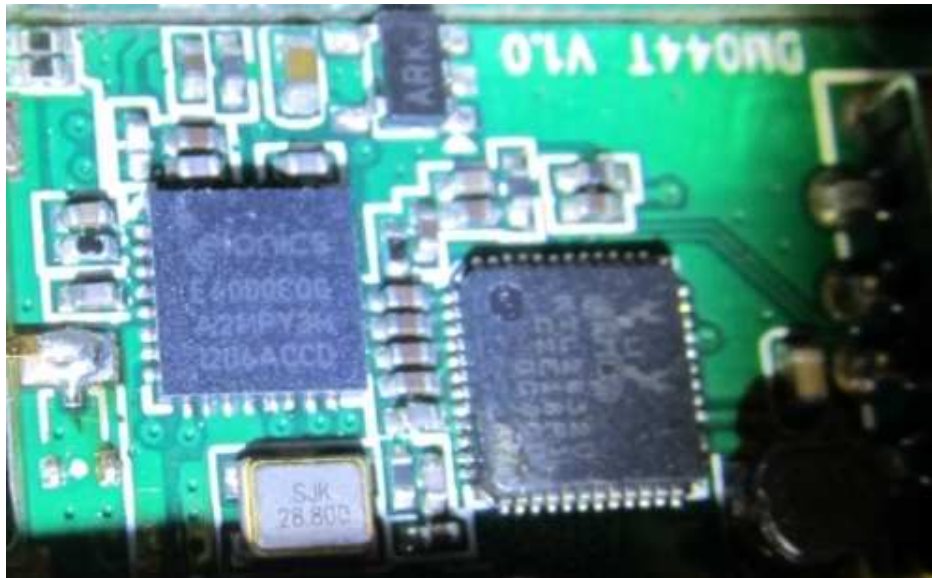
Bild 15: USB-DVB-T-Stick mit E4000 und RTL2832U
